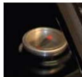
3 Датчик уровня топлива
